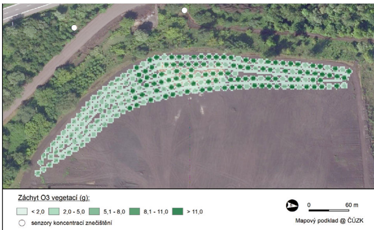
Obr. 15.6. Záchyt O 3 (g) ve stavu po výsadbě navrhované vegetace v síti 1 x 1 m na lokalitě Bartovice. Modelováno pro období dvou měsíců (na konci vegetační sezony). V případě stavu před výsadbou se nepředpokládá vzhledem k absenci jakékoliv stávající zeleně významný záchyt znečištění.
