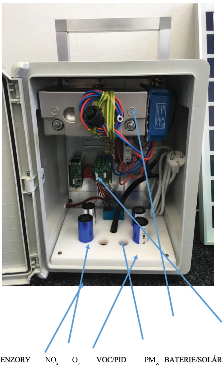
Obr. 11.2. Senzorový box. Senzory poskytují velmi rychlé měření v řádu minut, které jsou přenášeny prostřednictvím rádiové sítě LORA do databáze na VŠB.
