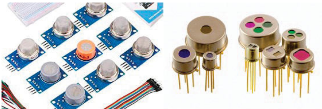
Obr. 4.3. Příklady polovodičových senzorů pro měření plynů (vlevo) a infračervených senzorů (vpravo).
